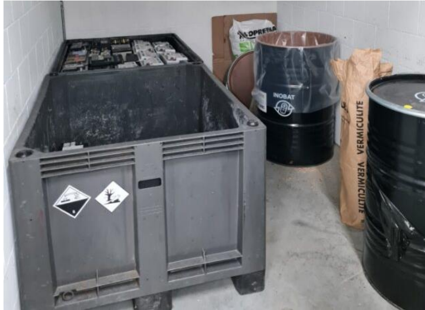
Bild 7: Aufbewahrung Sonderabfällen in separatem Raum, Entsorgungshof Schermen, Bern
