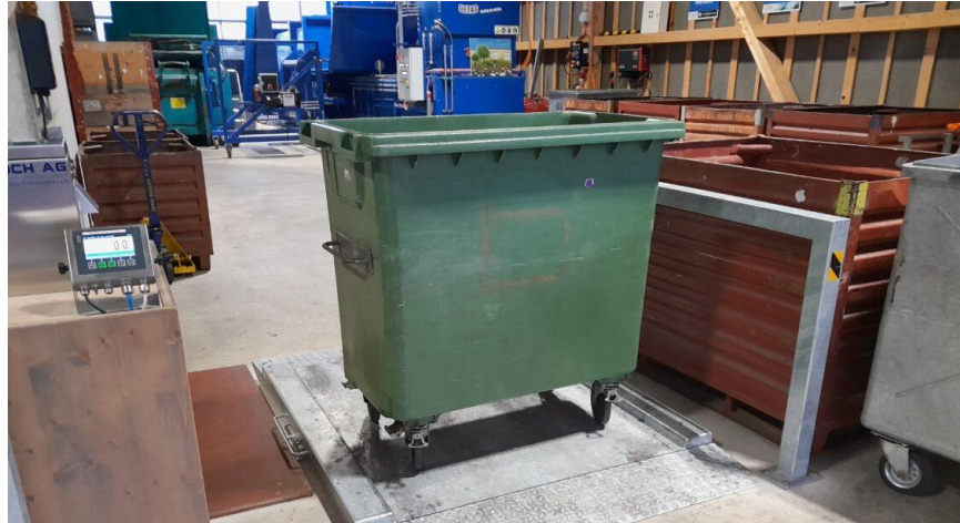
Bild 2: Waag-System Ökifhof, Zug,
