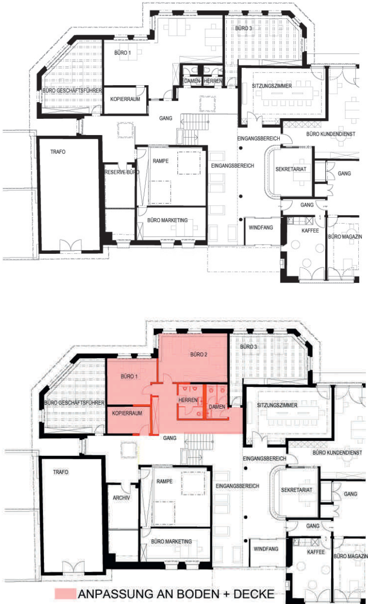
Bild 3: Obergeschoss (oben: bestehend / unten: neu)
